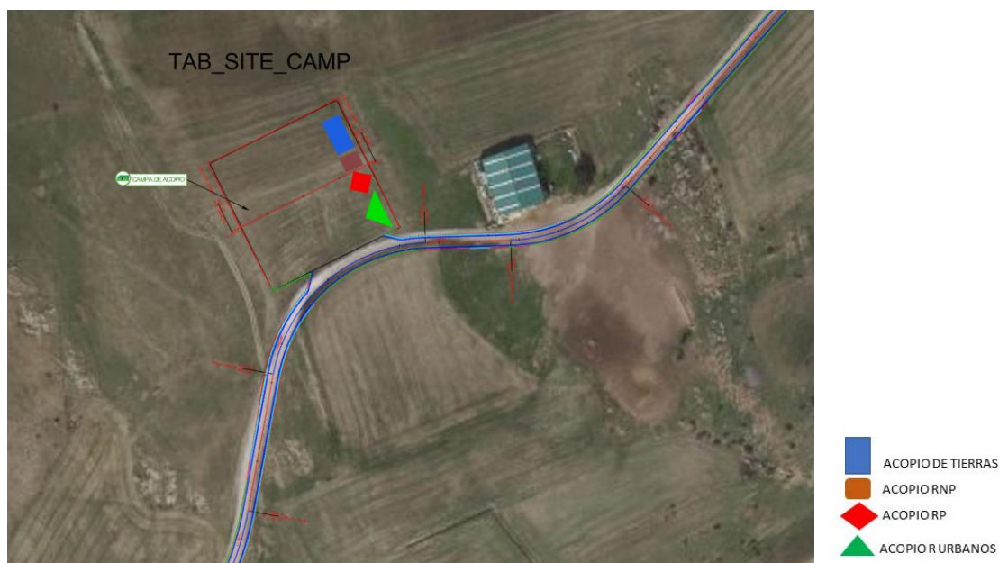
Imagen 2. Situación de punto limpio en el parque eólico
